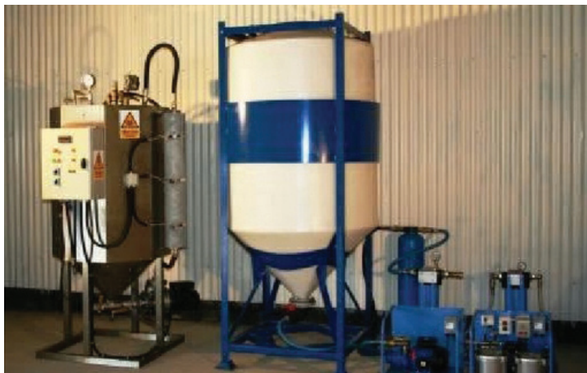
Instalație de producție a biodieselului – capacitate 2000-5000 L/24h (W2).
